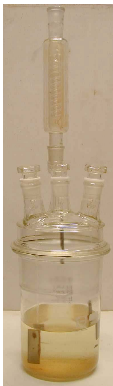
Рис. 37.4.2: РЕАКЦИОННЫЙ СОСУД С ПАРЦИАЛЬНЫМ КОНДЕНСАТОРОМ
